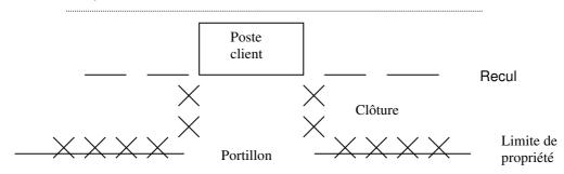
Un portillon avec serrure Strasbourg Électricité Réseaux installé en limite de propriété est toléré avec accès direct au poste selon schéma ci dessus
